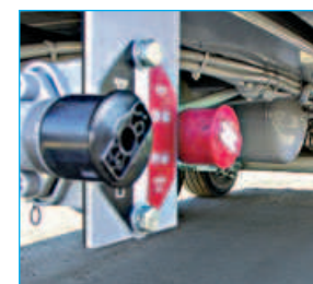
Frein de parc à commande pneumatique.
