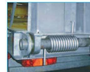
Aide au relevage des rampes.
