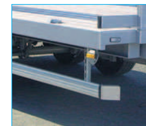
Protections latérales homologuées UTAC N° 97/05238 Protections arrière homologuées UTAC N° 91/512
