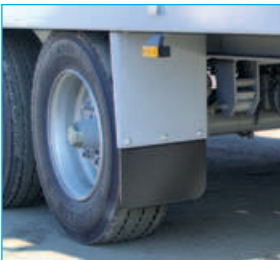
Les bavettes de protection captent l'eau projetée par les pneumatiques et en redirigent plus de 70% vers le sol, à l'abri des turbulences.
